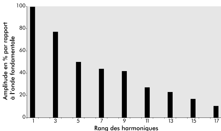
Figure 4 - Spectre des harmoniques pour une lampe fluorescente
